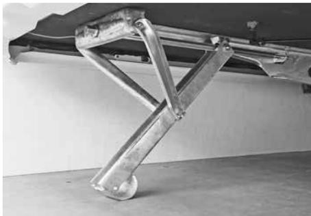
Die Ausdrehstützen befinden sich im hinteren und vorderen Bereich unter dem Caravan.
